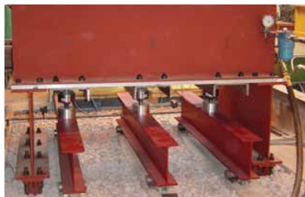
Simulerte laster fra tog utført ved The Nottingham University RTF.
